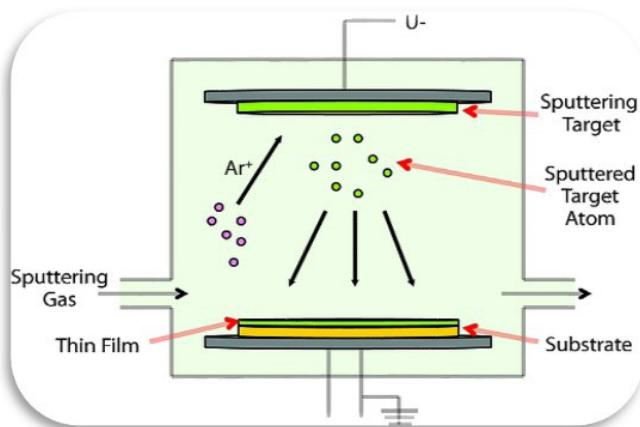
**Figure 9:** RF-sputtering technique.
